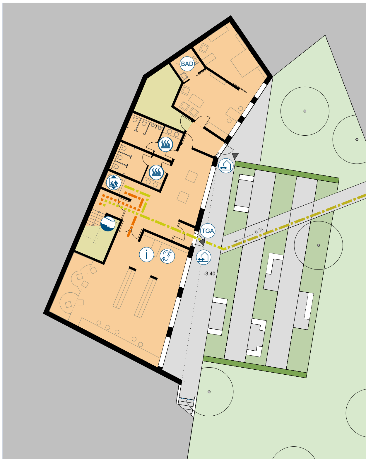
Grundriss Gartengeschoss Konzept Barrierefreiheit M 1:200
